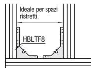
Materiale: EN AC-51400-T5 Equiv. Trattamento superficie: Anodizzato
