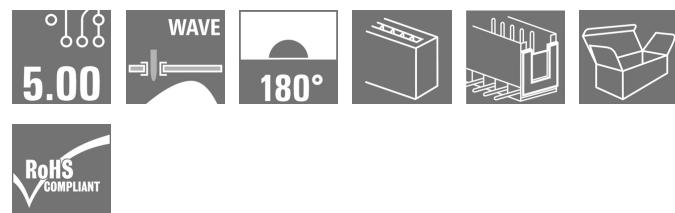
Connettori maschio con direzione d'uscita diritta a 180°. La lunghezza dei codoli a saldare è ottimizzata per saldature ad onda. I connettori presentano uno spazio per la siglatura e possono essere codificati.
