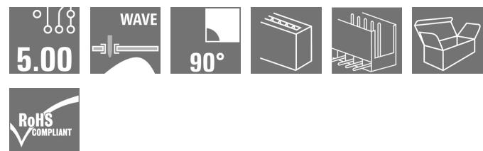
Connettori maschio con direzione d#92 uscita a 90°. La lunghezza dei codoli a saldare è ottimizzata per saldature ad onda. I connettori presentano uno spazio per la siglatura e possono essere codificati.
