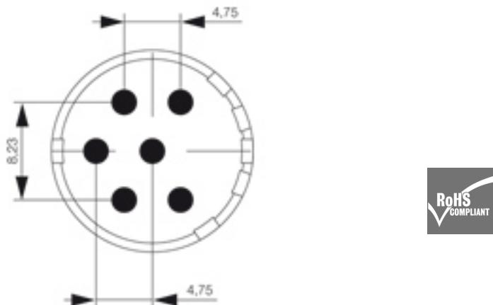
I connettori maschio M23 tondi consentono un numero elevato di cicli d'accoppiamento, forte corrente di carico e alta densità di contatto unitamente a dimensioni minime. Custodie, inserti e contatti a crimpare devono essere ordinati separatamente.
