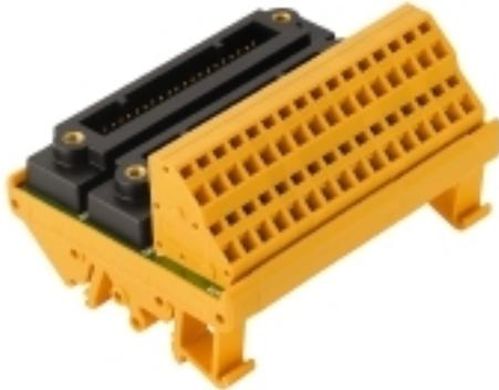
**Le interfacce analogiche sono provviste di connettori a 40 poli (KS). Sono disponibili delle versioni con disconnettori e punti di prova, estremamente utili per misurare tensione e corrente. Sono inoltre presenti delle versioni con utili perni aggiuntivi, per clienti che desiderano unire altri elementi (resistori ... ) per convertire tensione/corrente e per monitorare il loop di corrente.**
