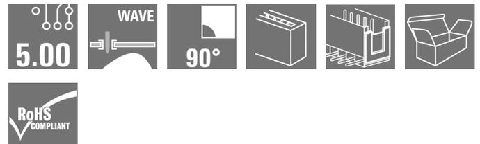
Connettori maschio con direzione d#92uscita a 90°. La lunghezza dei codoli a saldare è ottimizzata per saldature ad onda. I connettori presentano uno spazio per la siglatura e possono essere codificati.
