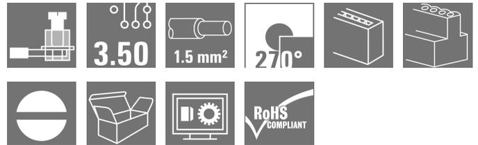
Connettori femmina con collegamento a vite in tecnica a staffa di serraggio per collegamento conduttore in passo 3,50 mm. Presentano uno spazio per la siglatura e sono codificabili.
