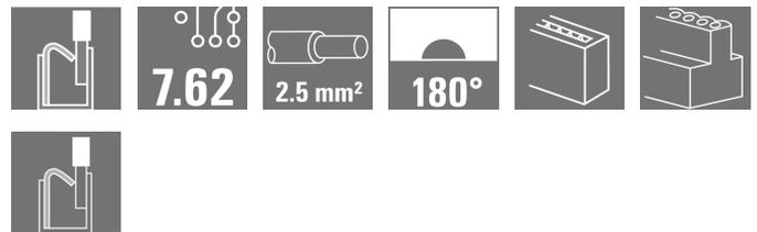
Striscia di connettori maschio inversi a 180° con tecnologia di collegamento PUSH IN per il cablaggio in campo da 2,5 mm<sup>2</sup> con passo 7,62. Ideale anche come soluzione di protezione contro i contatti accidentali per le tensioni inverse.
