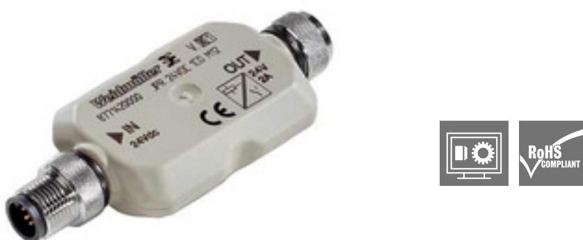
Gli accoppiatori a relè JPR nella custodia JACKPAC IP68 sono offerti con o senza separazione galvanica. L'amplificatore di commutazione amplifica uscite di commutazione 24 V DC a max 2 A. La tensione di commutazione all'uscita è condotta tramite un ripartitore a T.
