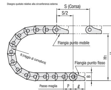
Materiale: Plastica speciale Temp. d'esercizio: -30°C ~ 100°C Classe di infiammabilità UL94-V2
