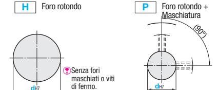
\* Per i dettagli delle dimensioni sede chiavetta, vedere **P1377**. Per la selezione di diam. foro albero 10 e larghezza sede chiavetta 4.0mm (altezza 1.8mm) per il foro con sede chiavetta Nuovo JIS, specificare **NK10**.
