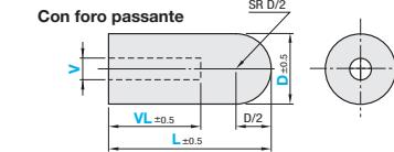
Per il tipo con foro passante, in assenza di specifica della dimensione VL vengono lavorati fori passanti. Se è richiesta la specifica della dimensione VL, il foro passante può essere lavorato, ma non può essere arrestato in SR.
