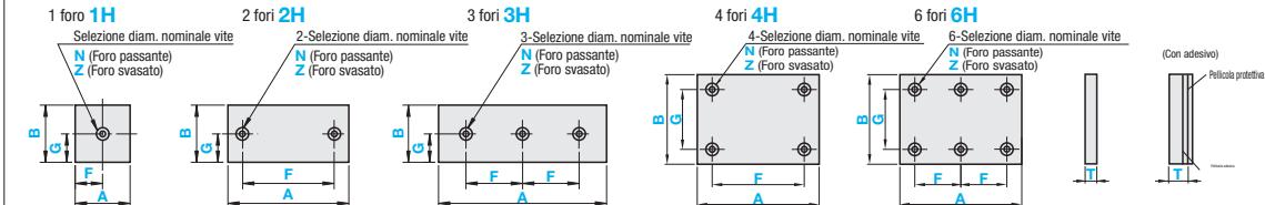
Nel tipo con adesivo e T5 o superiore, il nastro adesivo può staccarsi dal corpo. Utilizzarlo come fissaggio temporaneo o insieme a bulloni.
