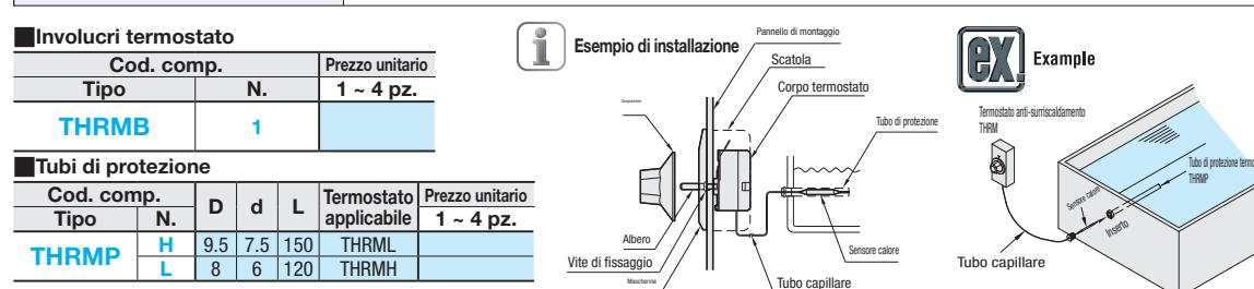
Fare attenzione alla combinazione di termostato e N. L/H del tubo di protezione.
